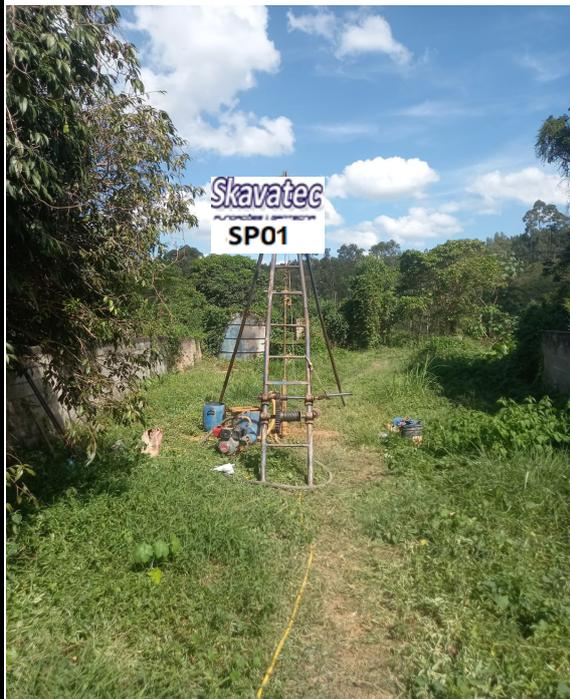
**Foto 1 - Equipamento de Sondagem em Operação**
