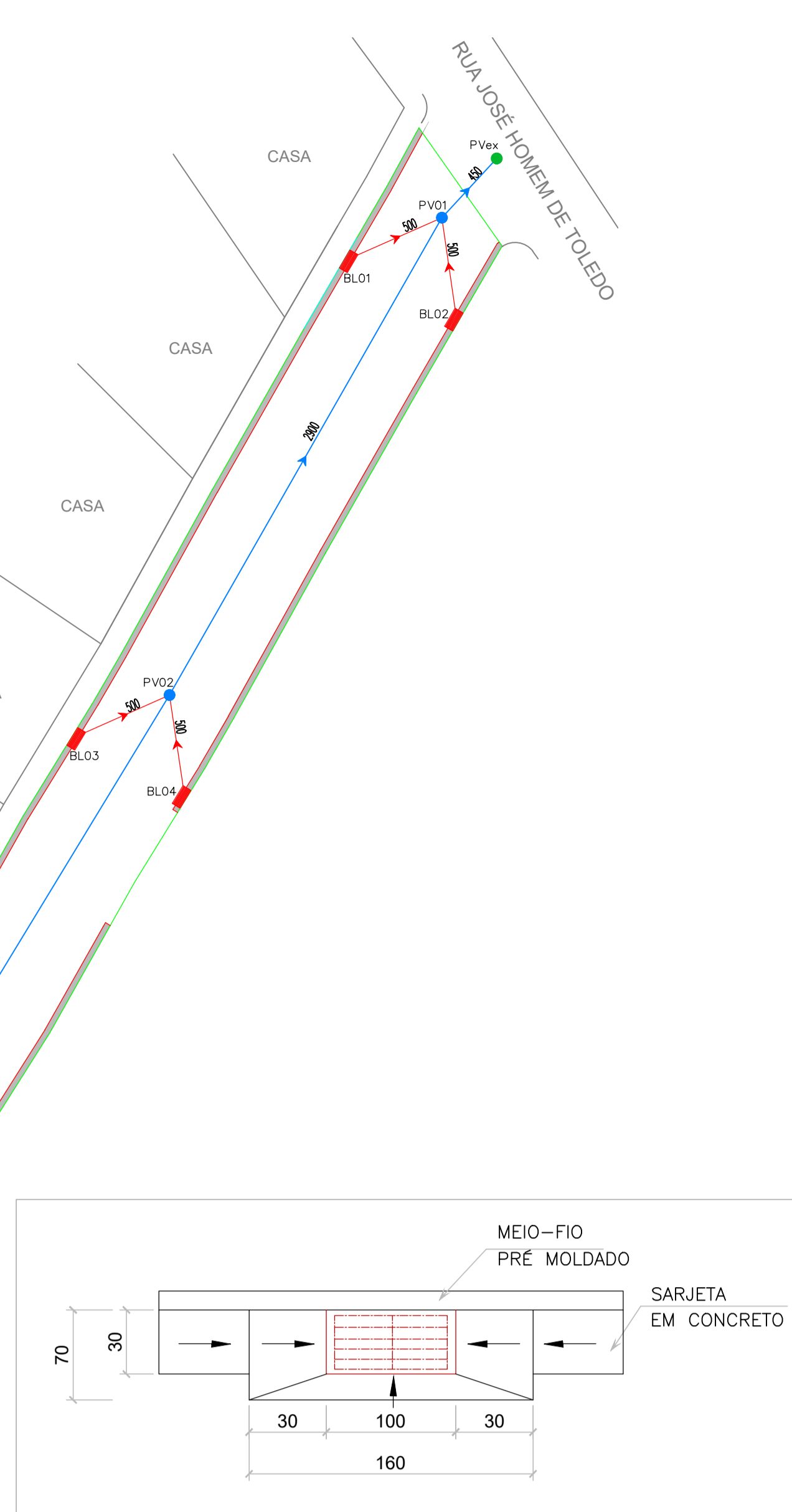
DEPRESSÃO DAS BOCAS-DE-LOBO-PLANTA sem escala
