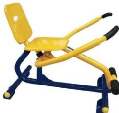
Devem ser instalados nas bases de concreto indicada em projeto, com o objetivo de propiciar a prática de exercícios físicos, principalmente aos idosos. A estrutura dos aparelhos deve ser de tubo de aço carbono, com solda MIG e pintura eletrostática de alta resistência. Sua fixação deve ser no piso de concreto por meio de parafusos tipo Parabolt 3/8"x2.1/4" zincados. Esta etapa inclui execução, fornecimento, transporte e manutenção de todos os materiais necessários.
